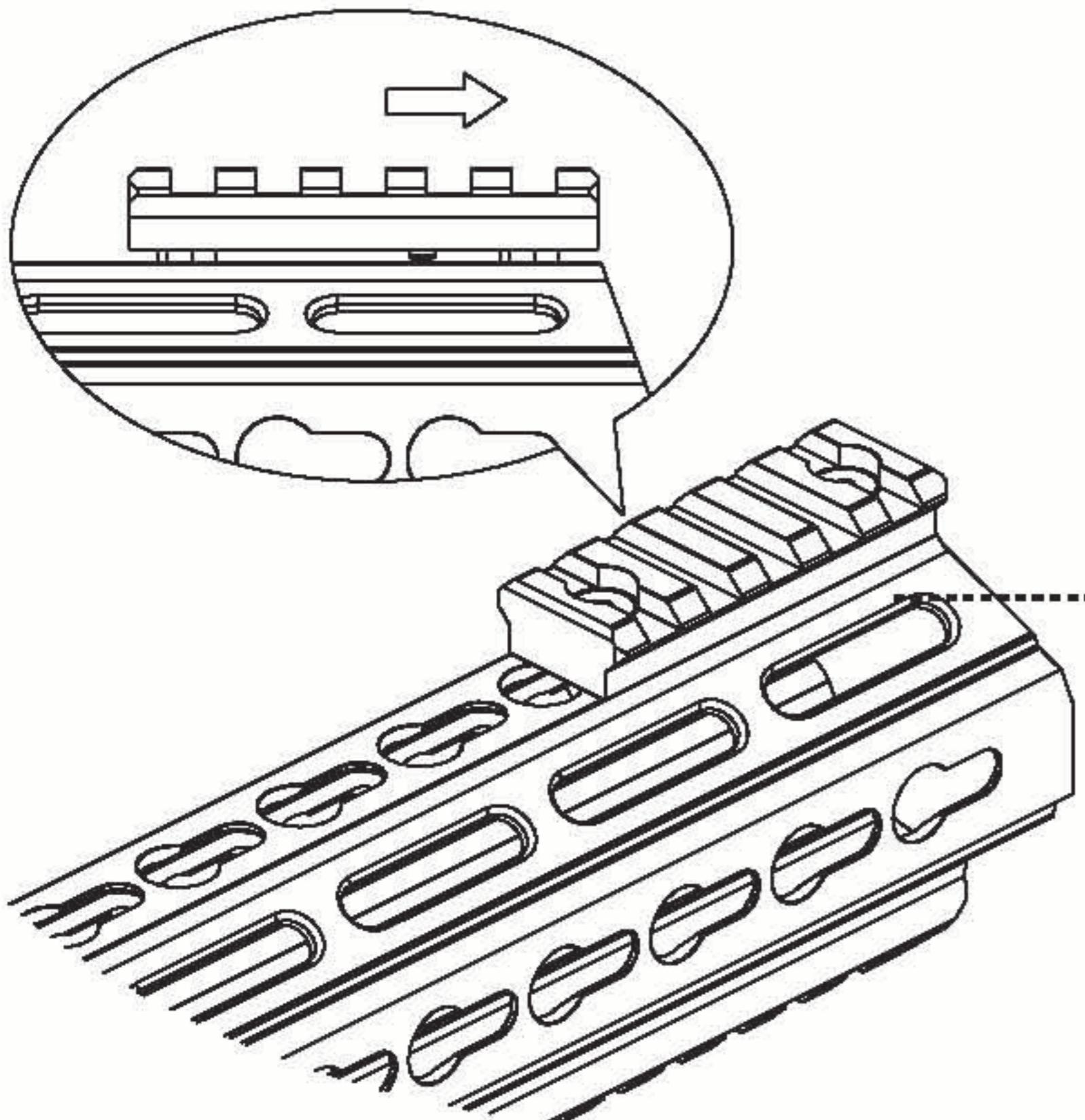
3-2 推動軌道條直到插銷抵到孔的邊緣，再鎖緊六角螺絲
