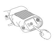
用六角板手調整馬達間隙螺絲 (出廠時已調整好)
