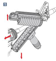
將護木固定環依方向往後 拉再卸下護木。 Pull back the delta ring and replace the R.I.S.
