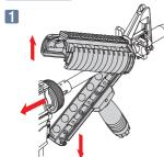
將護木固定環依方向往後 拉再卸下護木。 Pull back the delta ring and replace the R.I.S.
